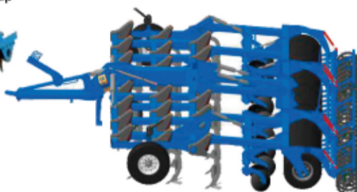
Борона пружинная АКМ-24 прицепная однорядная, ширина 25 м
